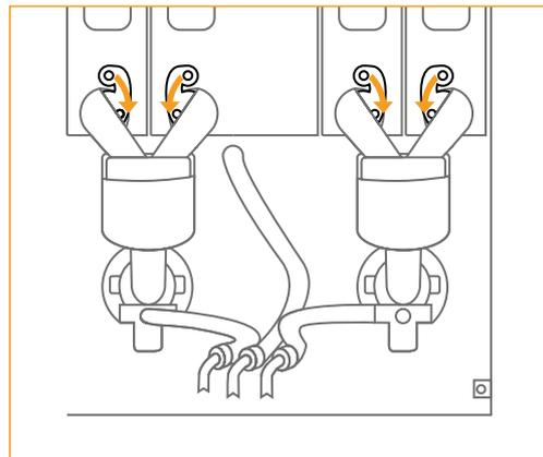
**05** Schließen Sie die Verschlusskappen und drehen Sie zum Entnehmen die Produktrutsche im Uhrzeigersinn.
