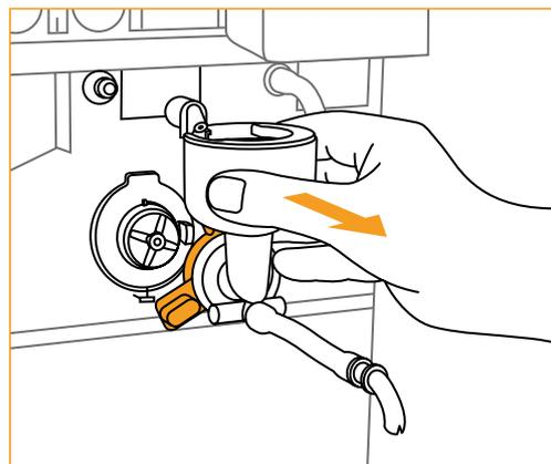
**07** Die Mischerschale nach vorne abziehen und Schlauch aus der Halterung drücken. Entnehmen Sie die Mischerschale.
