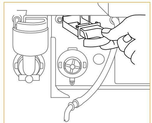
**08** Nach Demontage der Mischerschale und Produktrutschen die Absaugung für Mischerschale entnehmen und reinigen.
