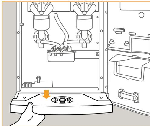
**01** Entnehmen und entleeren Sie die Tropfschale, reinigen Sie das Tropfgitter von innen und außen mit coffee perfect Automatenreiniger.
