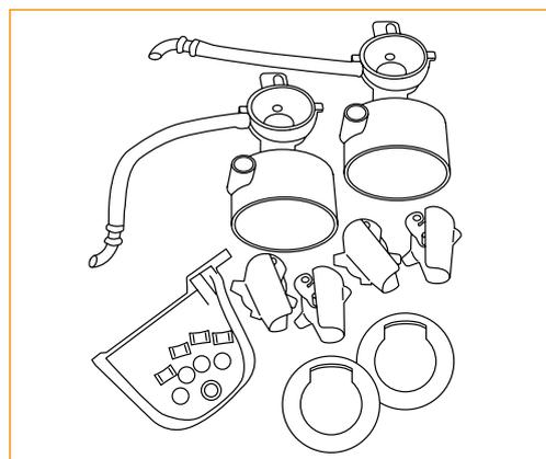
**09** Reinigen Sie alle Teile mit coffee perfect Kunststoff & Edelstahlpflege und heißem Wasser. Trocknen Sie diese, es darf keine Feuchtigkeit vorhanden sein.
