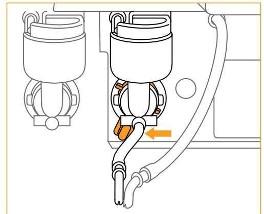
**06** Bajonettverschluss der Mischerschale (oranger Hebel) unten nach links drehen.
