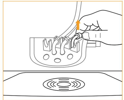
**02** Entnehmen Sie die Auslaufschläuche aus der Auslaufhalterung indem Sie diese nach oben abziehen.
