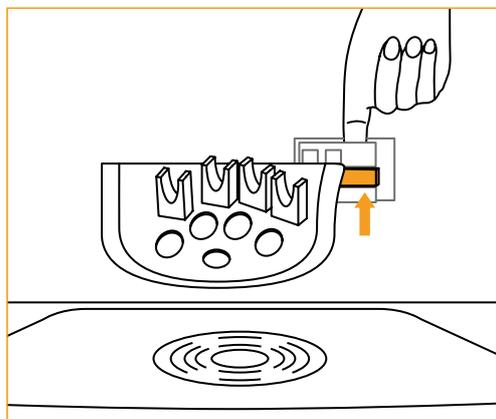
**03** Entnehmen Sie die Auslaufhalterung, indem Sie rechts den mittleren Kunststoff-Steg von hinten aus der Metallhalterung drücken.
