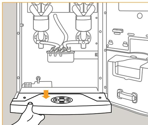
09 Entnehmen und entleeren Sie die Tropfschale, reinigen Sie das Tropfgitter von innen und außen mit coffee perfect Automatenreiniger.
