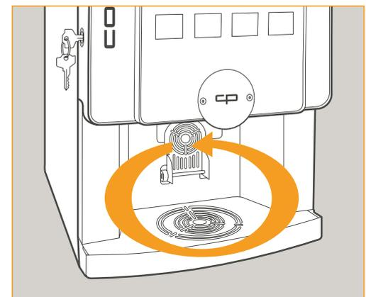
10 Reinigen Sie ebenso den Ausgabebereich sowie den Tassentisch. Schließen Sie das Gerät. Das Gerät ist wieder betriebsbereit.
